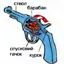
Револьвер Має магазин із гніздами на 5-6 патронів; натискання на спусковий гачок викликає частковий поворот барабана, встановлення чергового гнізда у відповідне положення і постріл
